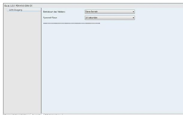
Die Sperrzeit ist der einzige Parameter der im Slavebetrieb parametrieren werden kann. Er gibt die Totzeit zwischen der Aussendung von zwei Signalen an.
