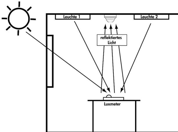
Um diese Anpassung vorzunehmen, muss ein Luxmeter an dem Ort positioniert werden, an dem der gewünschte Luxwert erreicht werden soll. Die Beleuchtung muss eingeschaltet sein (Leuchtstofflampen bitte 10 Minuten aufwärmen lassen). Dann wird der Luxwert z.B. auf dem Schreibtisch gemessen. Anschließend muss der Lichtwert an der Decke ermittelt werden. Dies kann erfolgen indem ein Luxmeter an die Position des Präsenzmelders gehalten oder aber der Luxwert vom Präsenzmelder auf dem BUS ausgegeben wird.
