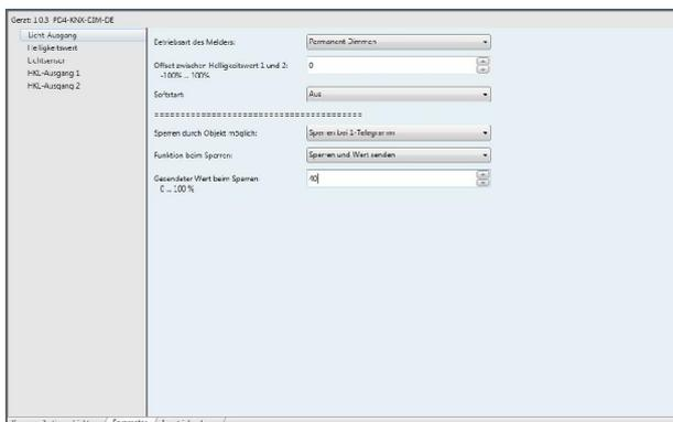
Der Permanentdimmer-Betrieb findet seine Anwendung in Bereichen, in denen ständig ein gewisser Luxwert erreicht werden soll (Bankvorraum, Passage etc.).
